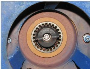
Mit Schneidwerk (Zerkleinerer) um Jauche, Gülle oder Fermenta zu fördern. Das Medium wird vor dem Ansaugen zerkleinert.
