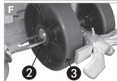
Demontiertes linkes Rad **3** wieder auf Achse stecken.
