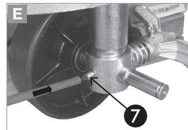
Deichsel um 90° drehen und Ersatzsplint **7** (Lieferumfang der Bremsenheit) einschrauben.
