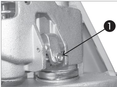
Das Hydraulische Ventil ist voreingestellt. Über Schraube ① lässt sich das Absenkenventil wie folgt justieren (Kontermutter öffnen):
