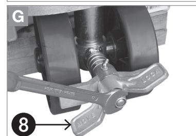
Mit Gabelschlüssel Nr.19 Bremse justieren:
