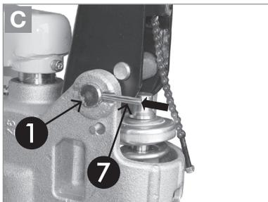
Mittels Hammer Achsbolzen **1** vollständig durch beide Aufnahmen schlagen. Dabei beachten, daß der rechte Splint **5** in der Mulde **6** liegt (siehe Abbildung B). Achsbolzen **1** durch Einschlagen des Federstiftes **7** fixieren.
