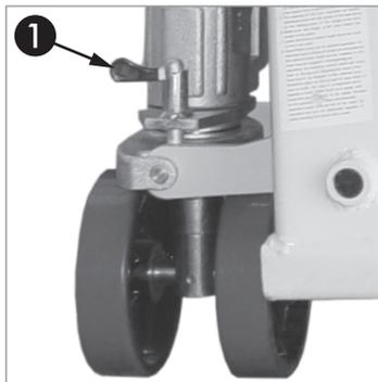
Seitenarretierung ① der Deichsel aktivieren, um ein ungewünschtes Verdrehen der Lenkrollen bei Traversefahrt zu unterbinden.
