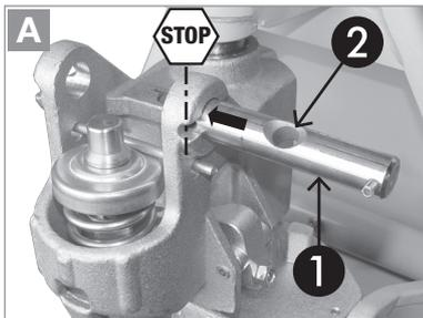
Achsbolzen **1** von rechts in die Aufnahme stecken - nicht durchschieben - siehe Abb. Beachten, daß das Kettenloch **2** in Richtung der Deichsel geneigt sein muss (wegen Kettenführung).
