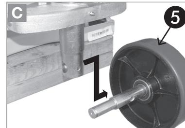
Achse mit montiertem rechten Rad **5** demontieren.
