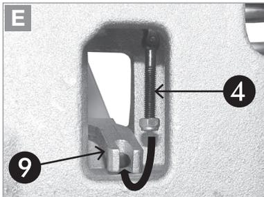
Den Bedienhebel auf Stellung „Heben“ (ganz unten) bringen. Dies ist der unterste Punkt der Kette.
