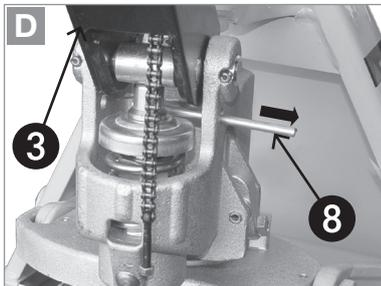
Deichsel **3** leicht nach unten drücken, bis der Sicherungsbolzen **8** entlastet ist. Den Sicherungsbolzen **8** herausziehen.
