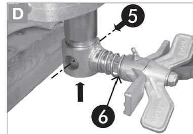
Bremseinheit **6** von unten aufschieben - die Öffnungen für die Achse müssen deckend sein.
