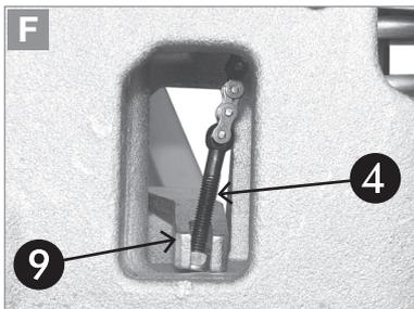
Kette **4** wie abgebildet in die Halterung **9** einhängen. (Halterung dazu anheben).
