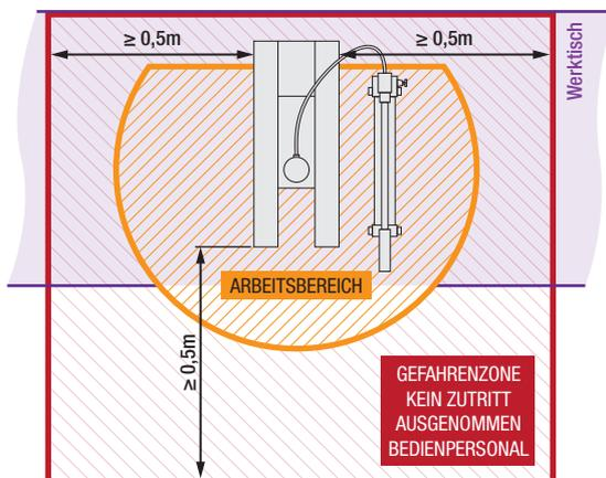
Das Bedienpersonal muss in die Restgefahren, welche im Betrieb der Presse bestehen, ausführlich unterwiesen werden. Dies sind vor allem: Schnitt-, Quetsch- und Risswunden - siehe 2. Gefahrenanalyse.
