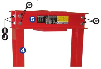
➡ Richten Sie den Rahmen mit einer Winkellehre im rechten Winkel aus und ziehen Sie alle Schrauben und Muttern fest an (A [C+D], B [C+D] und G [I+J]). Kontrollieren Sie nach dem Festziehen den rechten Winkel des Rahmens erneut!
