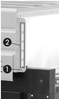
D.h. werden voraussichtlich nie Pakete mit einer Höhe z.B. >150mm verpackt. Sollte der Abstand zwischen Stabkette und Tunnelinnendach (lichte Höhe) auf 180mm (150+30mm) eingestellt werden. Somit ist weniger Energie als bei Maximalhöhe notwendig. Des weiteren können die Pakete schneller geschumpft werden.
