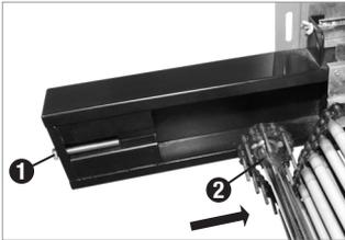
Sofern nur einzelne Stäbe getauscht werden müssen, das Band mittels Motorantrieb so positionieren, dass die defekten Stabketten nahe der Zugankerschrauben zum Stillstand kommen.
