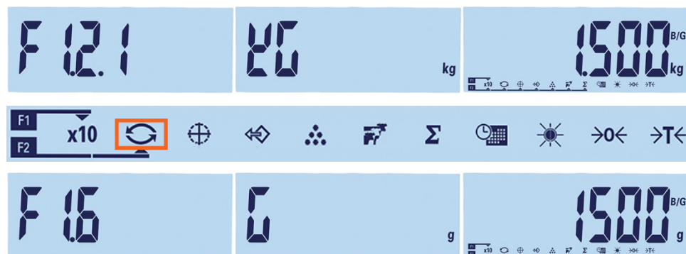
Abbildung 2-7: Umschalten der Maßeinheit: Kilogramm in Gramm
