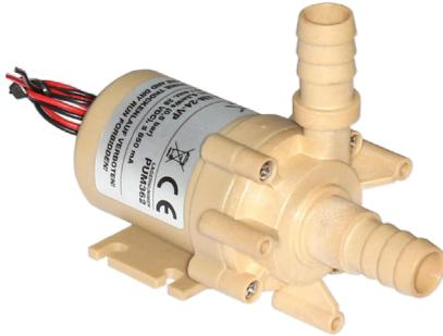
Durch die Vollkunststoffkonstruktion (ohne Bronze, Edelstahl oder Aluminium) bietet die Pumpe eine hohe Beständigkeit und ist für eine Vielzahl von Medien wie entsalztes Wasser und Lösungsmittel geeignet. Die verwendeten Materialien umfassen Polypropylen und Peek, während der Dichtring aus Silikon besteht. Aufgrund dieser Materialwahl ist die Pumpe auch bedingt gegen Laugen und Säuren beständig.
