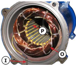
Sie sehen bei dieser Abbildung die Statorwicklung (O) des Motors und das Ölsensorkabel (I). Kontrollieren Sie den Stator auf Schleifspuren an der Innenseite (P) - dies würde auf ein defektes Lager hindeuten.
