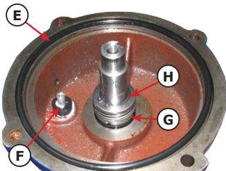
Sie sehen Dichtring1 (E) des Pumpenkörpers den Wassereintrittssensor (F) und den Wellendichtring2 (G) zwischen Ölkammer und Motor.
