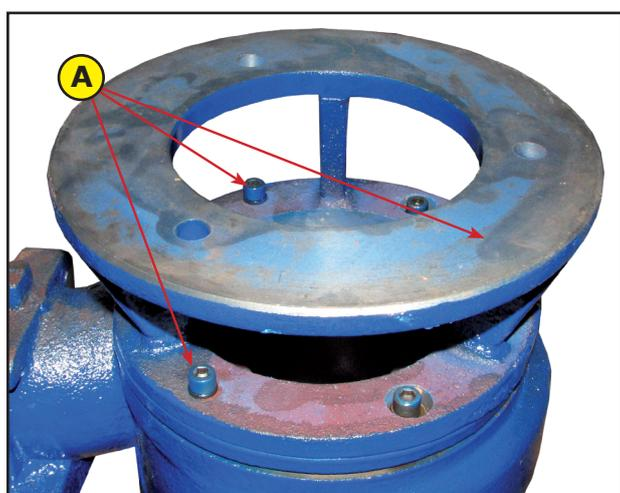
Öffnen Sie die 3 Imbusschrauben (A) und entfernen Sie den Standfuß.
