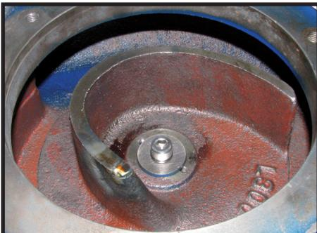
Pumpenrad mit integrierter hartmetall Schneidkante dadurch leichtes Fördern von Blättern, Algen, Stroh, Gülle usw. möglich.
