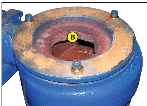
Im Anschluss öffnen Sie die 3 Imbusschrauben (B). Nun kann der Diffusor samt Schneidkante abgenommen werden.
