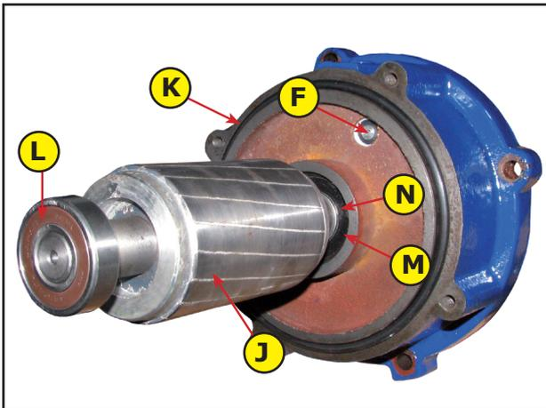
Bei herausgenommenem Rotor kann nun Dichtring2 (K) des Pumpenkörpers getauscht werden.
