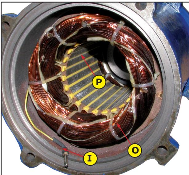
Sie sehen nun den Rotor (O) des Motors und das Ölsensorkabel (I).
