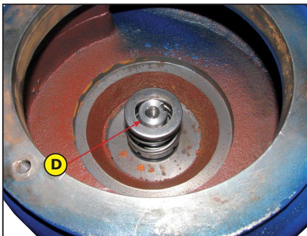
Nach Entfernen des Pumpenrades kann der Wellendichtring1 (D) zwischen Ölkammer und Pumpenrad abgezogen werden.
