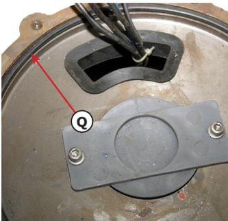
Um den Dichtring3 (Q) des Pumpenkörpers zu tauschen Öffnen Sie die 4 Schrauben des Deckels.
