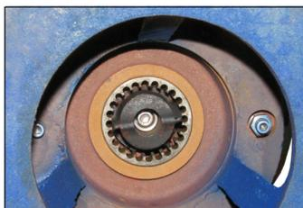
Mit Schneidwerk (Zerkleinerer) um Jauche, Gülle oder Fermenta zu fördern. Das Medium wird vor dem Ansaugen zerkleinert.
