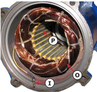
Sie sehen nun den Rotor (O) des Motors und das Ölsensorkabel (I).
