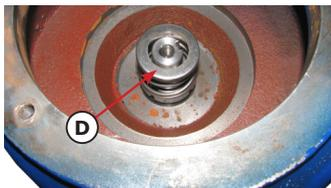
Öffnen Sie im Anschluss die 4 Schrauben, welche die Ölkammer befestigen und ziehen Sie die Ölkammer über die Welle ab.
