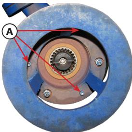
Öffnen Sie die 3 Schrauben (A) und entfernen Sie den Standfuß.
