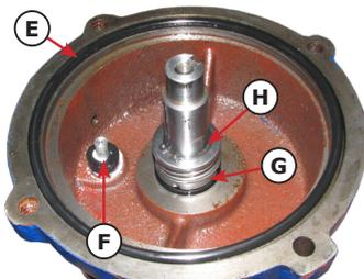
Ziehen Sie nun VORSICHTIG die Ölkammerwand von der Welle ab. Achtung Kabel von Sensor ist dahinter - nicht beschädigen!
