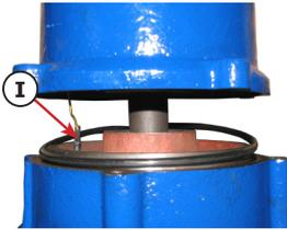
Ziehen Sie die Ölkammerwand ca. 5cm heraus und stecken Sie das Ölsensorkabel (I) ab.
