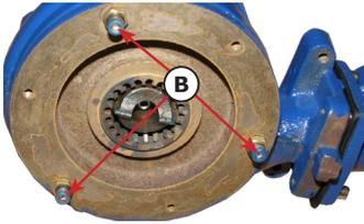
Im Anschluss öffnen Sie die 3 Schrauben (B).
