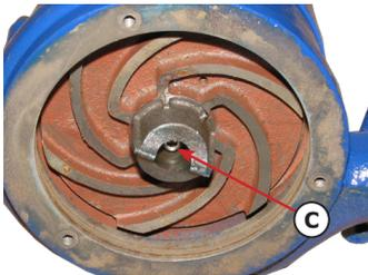
Öffnen Sie die Schraube (C) - Verschraubung des Pumpenrades.
