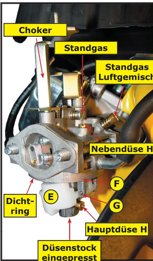
Bei Fehlfunktion des Nadelventiles (F) kann die Achse (G) des Schwimmers herausgezogen und der Ventilsitz sowie die Nadel entsprechend gereinigt werden.
