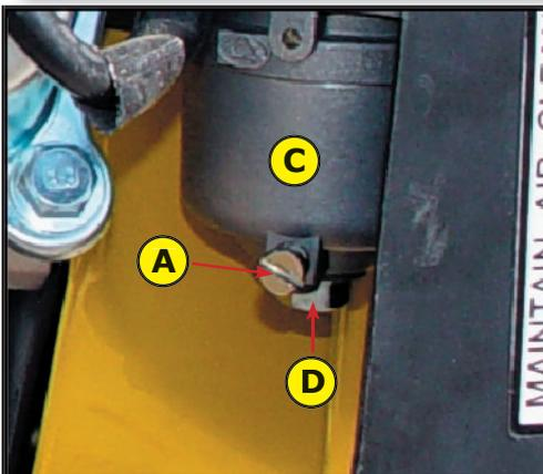
Entleeren Sie den Tank vollständig und lassen Sie über die Vergaserablassschraube (A) den Rest des Treibstoffes ab.
