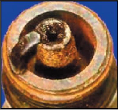
**Mittel- oder Masselektrode durch Motorklingeln angeschmolzen**
