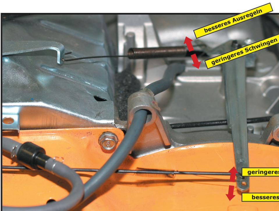
Um das Ausregelverhalten zu verbessern kann entweder das Gasgestänge am Regelhebel weiter nach aussen gehängt, oder die Regelfeder weiter nach innen gehängt werden.
