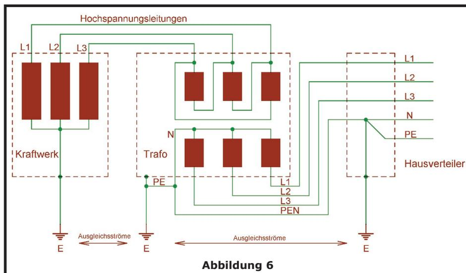
In Abbildung 6 können Sie erkennen dass nur drei Leitungen (L1,L2,L3) vom Kraftwerk zum Trafo notwendig sind. Die durch Asymmetrien bedingten Ausgleichsströme durch den Nulleiter fließen durch die Erde. Die Darstellung ist stark vereinfacht, in der Realität werden noch vielfältige Verteilungs- und Schutzmechanismen eingesetzt.
