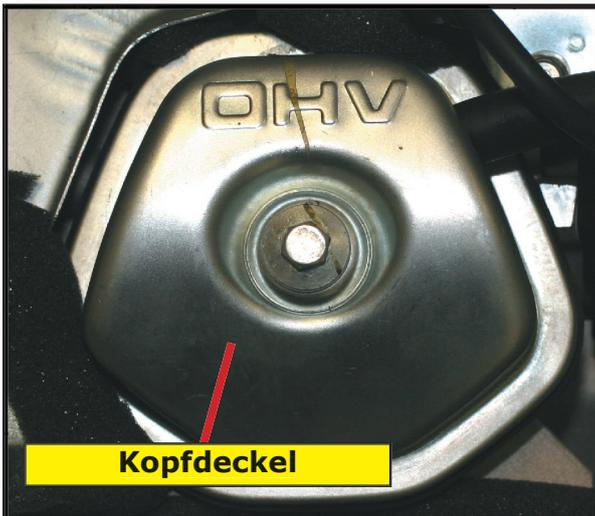
Falsches Ventilspiel kann sich in unruhigem Motorlauf, Fehlzündungen, mangelnder Motorleistung bemerkbar machen. Öffnen Sie die 4 Verschlusschrauben des Ventildeckels und drehen Sie die Kurbelwelle mit der Handstarteinrichtung so lange bis beide Ventile geschlossen sind (Ventile ganz heraus).
