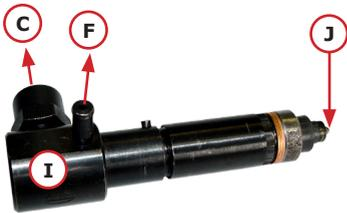
Sie können das Sprühbild überprüfen, indem sie die Einspritzleitung (C) im ausgebauten Zustand an die Düse anschließen. Legen sie ein weißes Blatt Papier so auf, dass die Düse senkrecht darauf zeigt (Abstand ca. 5mm). Drücken sie den Dekompressor und betätigen Sie kurz den START Schlüssel. Aus der Düse spritzt Treibstoff. Auf dem Blatt können Sie nun das Sprühbild ersehen - der Treibstoff sollte gleichmäßig auf dem Blatt verteilt sein.
