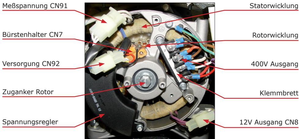
Sollten die Widerstände dem Sollwert entsprechen ist der Stator geprüft und in Ordnung.
