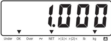
Sollte unter F222 die Auswahl MANUALL (Manuell) ausgewählt sein, können Sie das neue Zielgewicht manuell über die Tastatur eingeben. Drücken Sie die Funktionstaste um das neue Zielgewicht zu speichern.
