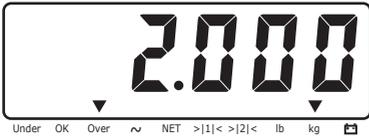
Drücken Sie die Funktionstaste um in den ÜBER/UNTER Modus zu gelangen.
