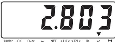
Drücken Sie die Funktionstaste (F). Sie können die Anzeige zwischen Pfund und Kilogramm umschalten.
