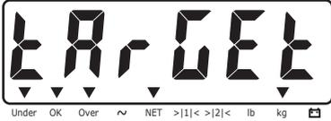
Halten Sie die Funktionstaste für 2 Sekunden. Das Terminal zeigt das „alte“ Zielgewicht an.
