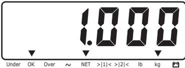
Aktuelles Gewicht (1,0 kg) nahe oder gleich dem Zielgewicht (1,0 kg). Innerhalb der Toleranz. Die „OK“ Anzeige leuchtet.
