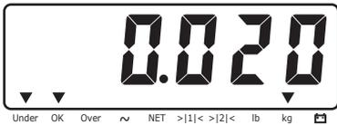
Drücken Sie die Funktionstaste erneut. Die Anzeige wechselt in den APW-Modus (=Gewicht des Einzelstücks, Average Piece Weight) - in diesem Beispiel 0,020 kg.
