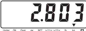
Drücken Sie die Funktionstaste (F). Das Terminal zeigt für 20 Sekunden 1 Kommastelle mehr an.
