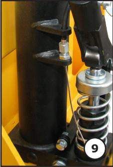
Führen Sie den Absenkseilzug des Griffs auf die Halterung des Hubzylinders und montieren Sie diesen dort (9).
