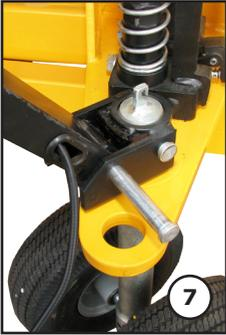
Entfernen Sie den Seegerring der Griffachse und ziehen Sie die Griffachse soweit heraus, dass der Griff eingesetzt werden kann (7).
