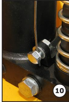
Klemmen Sie den Absenkseilzug an die Ventilhalterung an (10). Beachten Sie, dass das Seil straff geführt werden soll, aber keinen Druck auf das Ventil auslösen darf.
