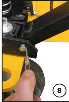
Schieben Sie die Achse wieder in die Führung und montieren Sie den abgenommenen Seegerring wieder (8).
