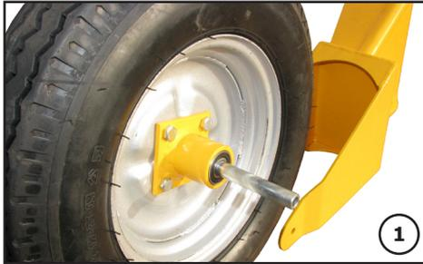
Führen Sie die Steckhülse in die Öffnung des Gabelrades (1) und schieben Sie die Distanzhülse (2) über die Hülse. Stecken Sie die Schraube samt Beilagscheibe (3) durch die Gabelradaufnahme. Befestigen Sie das Gabelrad mit der Mutter (4).
