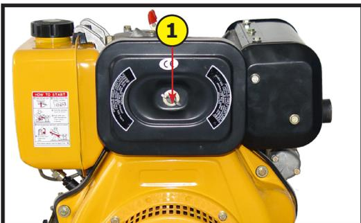
Öffnen Sie den Luftfilterkasten indem sie die Flügelmutter (1) aufschrauben.
