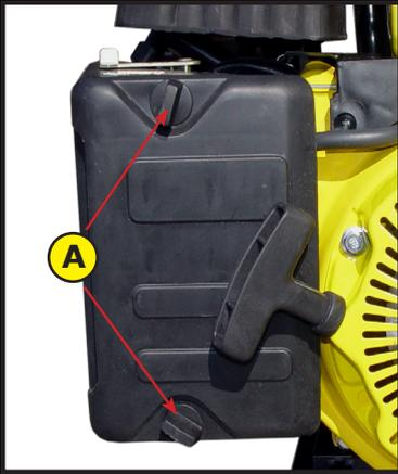
Öffnen Sie den Luftfilterkasten indem sie die 2 Schrauben (A) öffnen. Entnehmen Sie den Luftfilter, waschen sie ihn in sauberem Benzin aus und lassen sie den Luftfilter trocknen.
