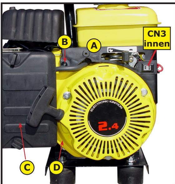
Demontieren Sie den Luftfilterkasten (siehe Luftfiltertausch) und im Anschluss den Luftleitkasten (C) um zur Zündspule zu gelangen.
