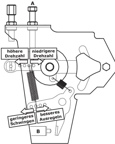
Mit der Einstellschraube (A) kann die maximale Drehzahl begrenzt werden. Im Auslieferungszustand ist die Drehzahl auf 3.600 U/min begrenzt. Die Drehzahl kann auch durch umhängen der Regelfeder am Leistungswahlhebel justiert werden.
