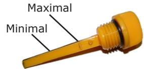
Kontrollieren Sie alle 3 Monate das Ölsieb und reinigen Sie dieses bzw. führen Sie gegebenenfalls einen Ölwechsel durch. Ölwechsel immer im warmen Zustand durchführen!
