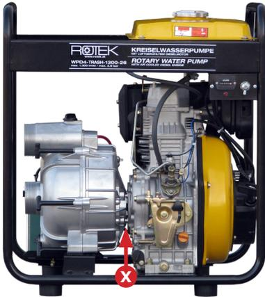
Einen defekten Wellendichtring erkennen Sie daran, dass an der Motorwelle an Punkt (X) Wasser austritt.
