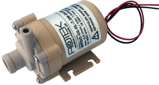
Durch die Vollkunststoffkonstruktion (ohne Bronze, Edelstahl oder Aluminium) bietet die Pumpe eine hohe Beständigkeit und ist für eine Vielzahl von Medien wie entsalztes Wasser und Lösungsmittel geeignet. Die verwendeten Materialien umfassen Polypropylen und Peek, während der Dichtring aus Silikon besteht. Aufgrund dieser Materialwahl ist die Pumpe auch bedingt gegen Laugen und Säuren beständig.
