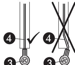
Schweißdraht immer parallel zum Schweißbalken führen!
