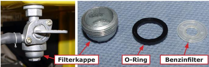
Schließen Sie den Treibstoffhahn und ziehen Sie den Benzinschlauch vom Benzinhahn ab. Wenn Sie nun den Benzinhahn öffnen sollte der Treibstoff herauslaufen. Sollte dies nicht der Fall sein, so reinigen Sie den Filter welcher im Benzinhahn integriert ist. Achten Sie beim Zusammenbau auf den korrekten Sitz des O-Ringes.
