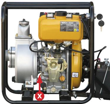
Einen defekten Wellendichtring erkennen Sie daran, dass an der Motorwelle an Punkt (X) Wasser austritt.
