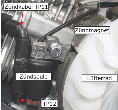
Sollte dies nicht der Fehler sein, so öffnen Sie nun CN9. Sollte die Zündung nun funktionieren so hat entweder das Kabel zum Zündschalter oder der Zündschalter selbst einen Kurzschluss gegen Masse. Beheben Sie den Fehler entsprechend. Besteht der Fehler weiterhin so demontieren Sie den Luftleitkasten um zur Zündspule zu gelangen.
