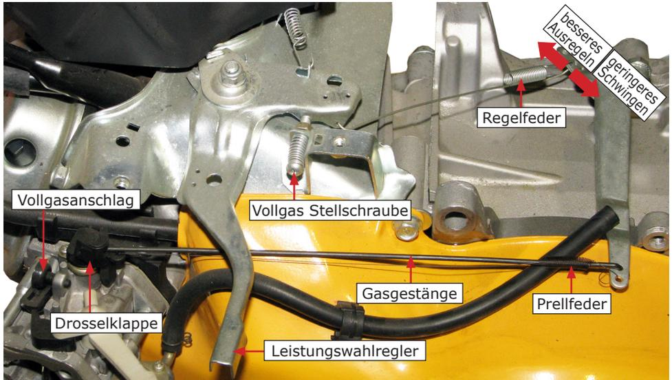
Hängen Sie das Gasgestänge auf der Seite des Vergasers aus (Prellfeder aushängen, Drosselklappe auf Leerlauf ziehen und Gestänge nach oben abziehen). Wenn Sie nun die Drosselklappe auf Vollgas drehen, so sollte das Ende des Regelgestänges ca. 5-7 mm Richtung Vollgas überstehen (Regelreserve).
