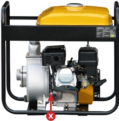
Einen defekten Wellendichtring erkennen Sie daran, dass an der Motorwelle an Punkt (X) Wasser austritt.
