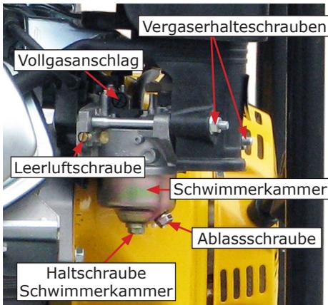
Öffnen Sie danach die Schwimmerkammer durch Aufdrehen der Halteschraube. Kontrollieren und reinigen Sie diese.
