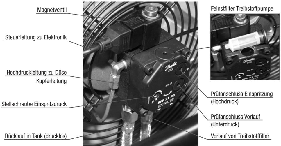
Die Pumpe wird über Motorwelle angetrieben (über Kunststoffmitnehmer) und saugt über Vorlauf Treibstoff an. Ausgang über Kupfer-Hochdruckleitung zu Düse. Überschüssiger Treibstoff wird über Rücklauf drucklos an Tank rückgeführt.
