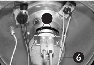
Zündelektrode sowie Treibstoffdüse können auch ohne Demontage der Halteplatte 6 demontiert werden. Zur einfacheren Diagnose von Verschmutzung sollte die Halteplatte 6 jedoch abgenommen werden. Hierzu die Schrauben ● öffnen und die Halteplatte samt Komponenten vorsichtig nach hinten ziehen - ACHTUNG die Hochdruckleitung ist aus Kupfer und nur bedingt biegsam.
