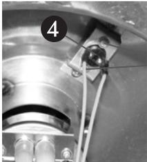
Der Bimetallschalter (Klixon) ④ befindet sich an der Rückwand der Brennkammer.
