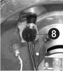
Der Fotowiderstand (LDR) 5 befindet sich an der Rückwand der Brennkammer. Montiert ist dieser LDR in einer Silikontülle 8. Diese Tülle wird in eine Röhre 9 geführt, welche zum Brennraum offen ist.
