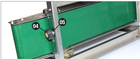
Förderband beidseitig mittels im Zubehör beiliegenden M8 Schrauben, Beilagscheiben (05) und Kordelmuttern (04) auf Rahmen montieren.
