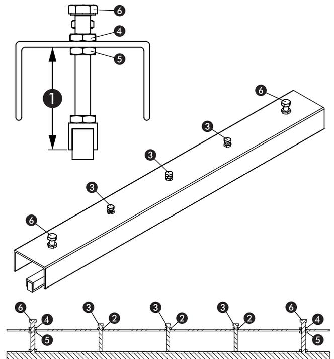
Alle 3x M6 Kontermuttern ② lockern und die 3x M6 Klemmschrauben ③ ein Stück vom Gummihalter entfernen (heraus schrauben). Dann durch Verstellen der Muttern ④ oder ⑤ die Position der Stellerschraube ⑥ und somit den Abstand ① auf das Sollmaß von 54mm justieren. Der Abstand ist beidseitig zu prüfen. Nach Justage Muttern ④ und ⑤ anziehen. Schrauben ③ auf Gummihalterwinkel schrauben und mittels Kontermuttern ② fixieren.
