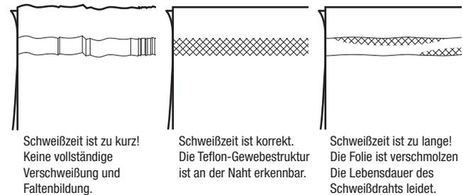
Üblicherweise muss zu Arbeitsbeginn die Schweißdauer um ca. 0,5s höher eingestellt werden. Nach 20-40 Arbeitszyklen kann die Schweißzeit wieder auf den Ausgangswert reduziert werden, da die Restwärme des Schweißdrahtes höher ist.
