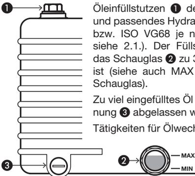
Öleinfüllstutzen ① der Vakuumpumpe öffnen und passendes Hydrauliköl einfüllen (ISO VG32 bzw. ISO VG68 je nach Einsatztemperatur - siehe 2.1.). Der Füllstand ist korrekt sobald das Schauglas ② zu 3/4 mit Hydrauliköl gefüllt ist (siehe auch MAX Markierung neben dem Schauglas).
