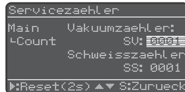
Die Servicezähler dienen zur Planung von Instandhaltungsintervallen von Vakuumpumpe und Schweißbeinheit. Die Zähler können nach Bedarf verwendet und rückgesetzt werden.
