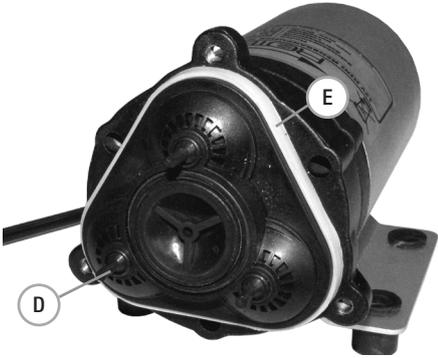
Nehmen Sie den Diffusorkörper (D) vom Membranfilm (E) ab (Nach vorne abziehen).
